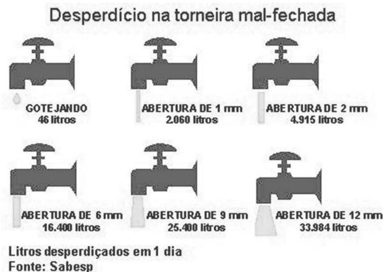
Figura 12: Desperdício de água por dia em torneiras com vazamento
