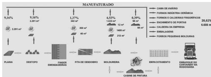
Figura 18: Processo de manufatura das esquadrias Brondini
